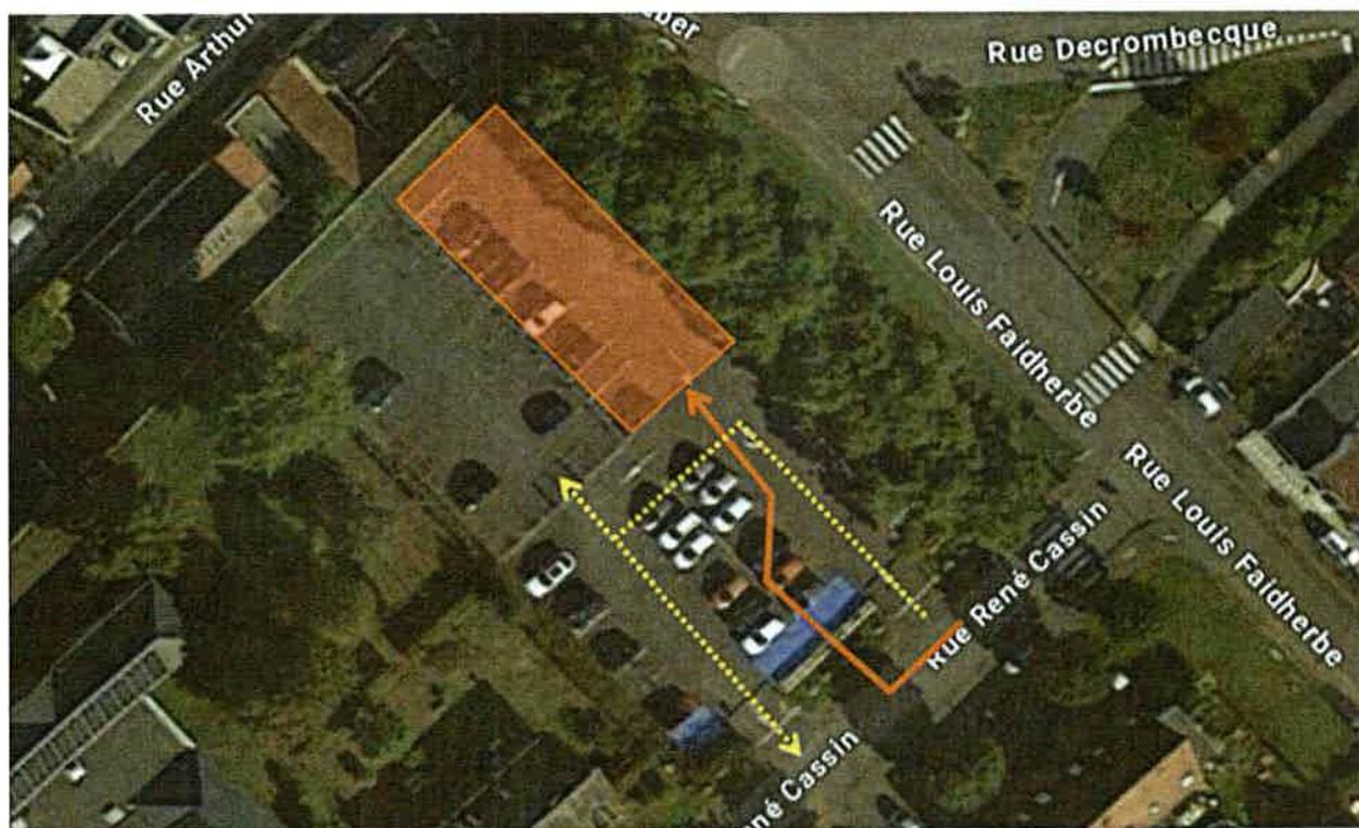
Ce projet, d'un montant de 141 000 € TTC, va permettre de collecter les eaux pluviales de l'ensemble du parking, soit une surface d'environ 2 000 m<sup>2</sup>. Ainsi, pour une pluie de 50 mm, ce sont 100 m<sup>3</sup> qui ne rejoindront plus le réseau d'assainissement. Le projet prévoit la pose de caissons d'infiltration à hauteur de 113 m<sup>3</sup>, sous le parking. Une aide financière a été demandée à l'agence de l'eau Artois Picardie.
